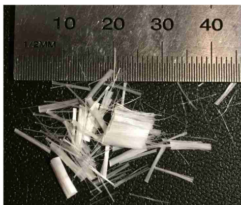
Mynd 4: PVA trefjar, 8mm langir og 40µm í þvermál
