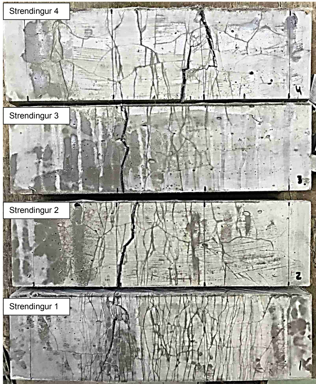
Mynd 10: Sprungumyndun á undirsíðu allra strendingana úr ASTM C1609 prófum. Hér er búið að bleyta yfirborð strendingana til að gera skýrari skil á sprungumyndun á yfirborði.
