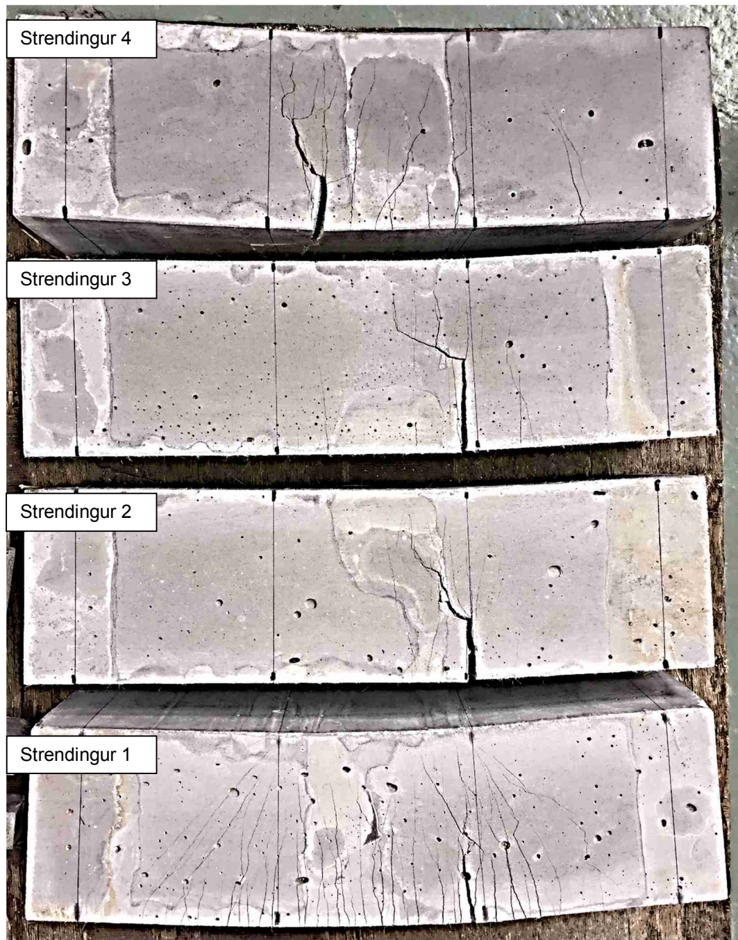
Mynd 9: Sprungumyndun á hliðum allra strendingana úr ASTM C1609 prófum.
